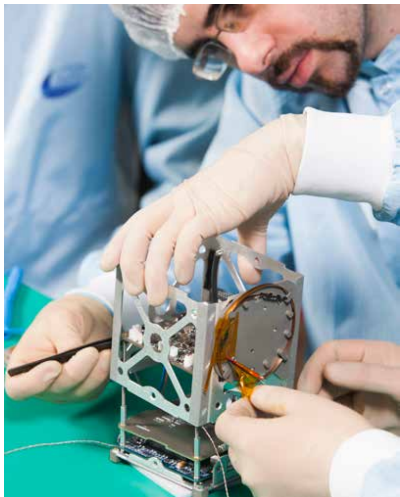
Assemblage du nano-satellite OUFTI-1 au Centre spatial de Liège (CSL-ULiège). Voir p. 49.
