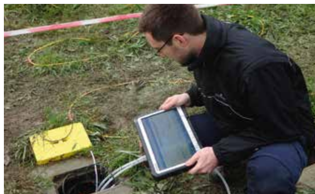
Mesure de la qualité et de la température de l'eau souterraine dans un forage (Source : HGE, http://www.facsu.ulg.ac.be/cms/c_681446/en/hydrogeology-and-environment-geology )
